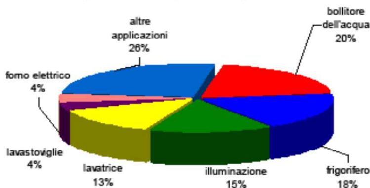
Fig.2.17_Distribuzione del consumo di energia elettrica di una famiglia italiana di 4 persone
