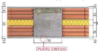
Ponte termo - acustico Pilastro parete - Correzione ordinaria
