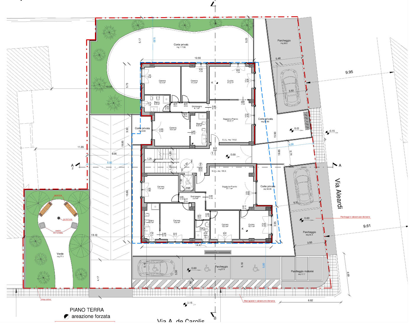
Planimetria piano TERRA stato MODIFICATO scala 1:250
