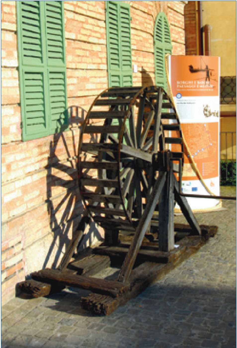
La ruota dei funai, simbolo del lavoro di produzione della corda. The wheel for making ropes, symbol of the hard job to produce ropes.
