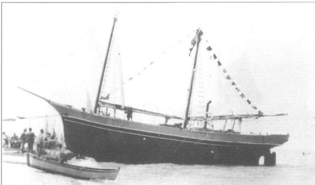
Il "Cavour" dell'armatore De Martino Pasquale di Trani, tipo goletta, si è incagliato sulla ariva mentre scivolava a mare per il varo. In primo piano il barchetto che serviva a trasportare e quindi gettare l'ancora dalla parte della poppa.
