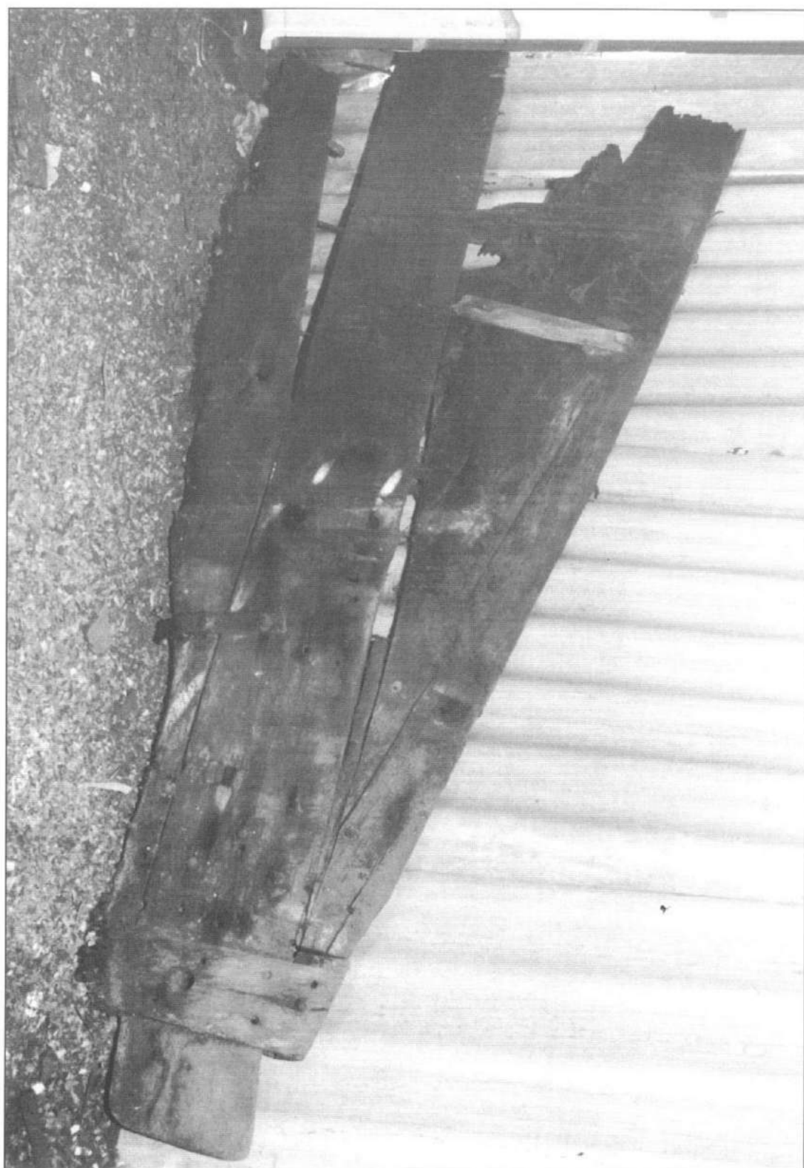
Timone di una lancetta risalente a circa 80 anni fa, dove sono visibili le tre distinte componenti.
