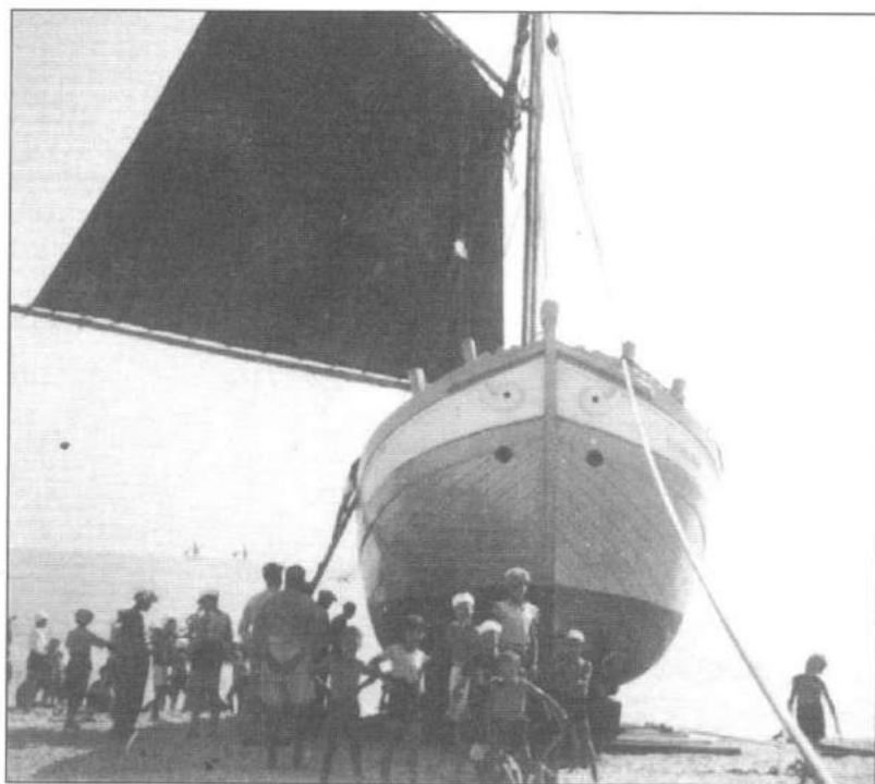
Motopeschereccio tipo trabaccolo con vela "a randa" per un armatore civitanovese.
