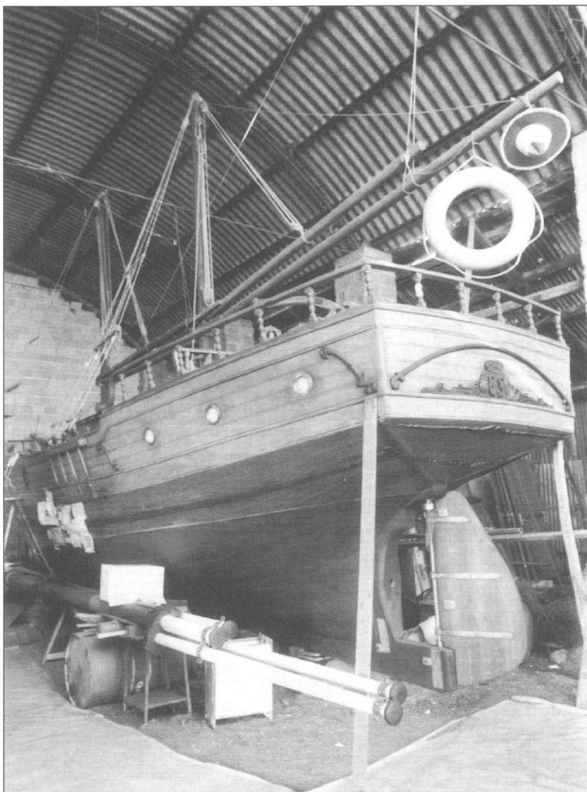
La bellissima poppa dela goletta con in primo piano il timone, gli alberi ed i pennoni già montati.
